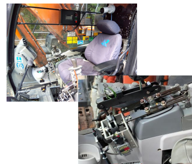
後付け遠隔操縦装置 (RemoDrive) を搭載したバックホウのコクピット
